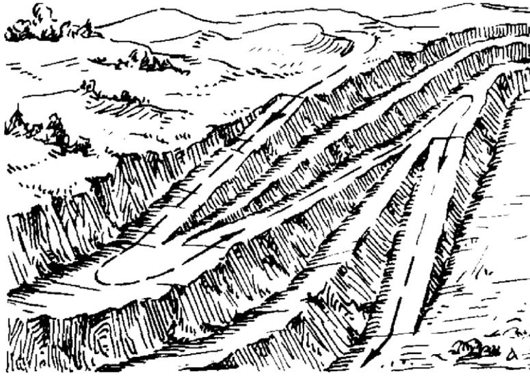
Fig. Aspect du bord de la carrière lors d'une découverte avec un système de tranchées intérieures en boucles.
